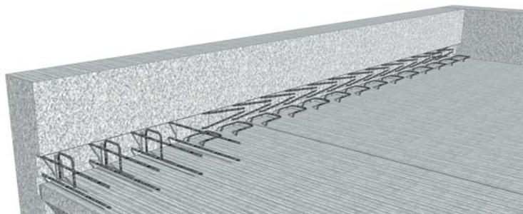
⚠ S'assurer qu'il ne reste aucun morceau d'enveloppe du boîtier dans l'engravure avant coulage de la dalle.
