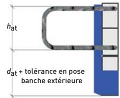
2 Sortir les armatures dépassantes du boîtier pour les repositionner en sens inverse.
