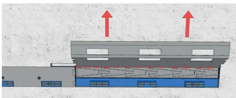
4 Ôter le dispositif aimanté et opérer un glissement de l'ensemble en le tirant vers le bas. Chaque système de fixation dispose d'une gorge pour être appréhendée.
