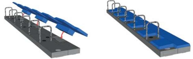
2 Le système GAMMBOX<sup>2</sup> BPS se pose impérativement de la gauche vers la droite. Emboîter les ensembles successivement en s'assurant de leur parfaite jonction entre eux.
